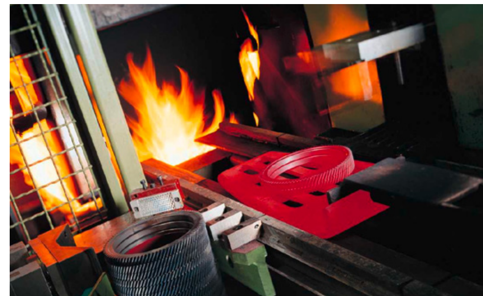
Beschickung eines Drehherdofens. Bild Aichelin
