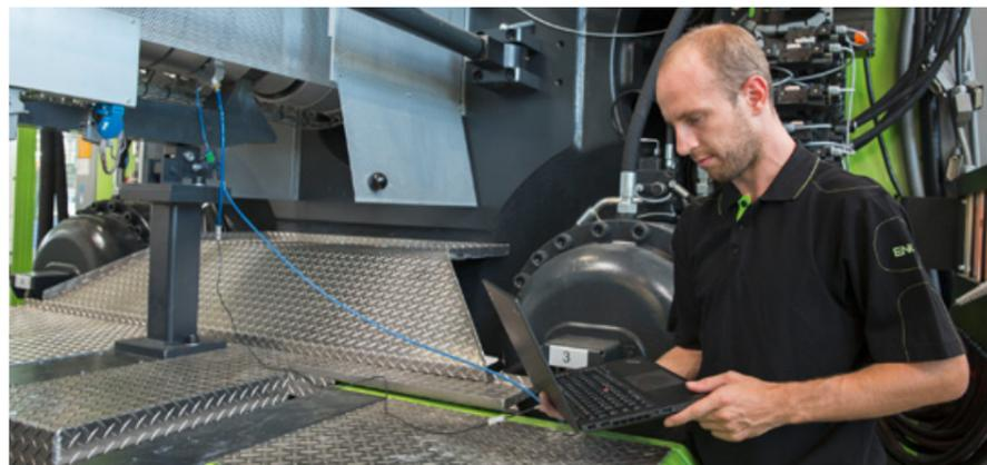
Der Kunststoffverarbeiter Schöfer in Schwertberg kontrolliert mit Hilfe des neuen e-connect.monitor den Zustand der Plastifizierschnecke einer großen ENGEL duo Spritzgießmaschine. Mit der zustandsbasierten, prädiktiven Instandhaltung lassen sich ungeplante Anlagenstillstände vermeiden. Bild: ENGEL
