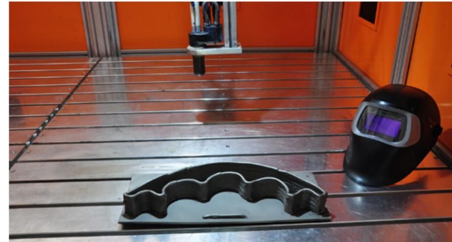
3D gedrucktes Titanteil. Bild: RHP Technology
