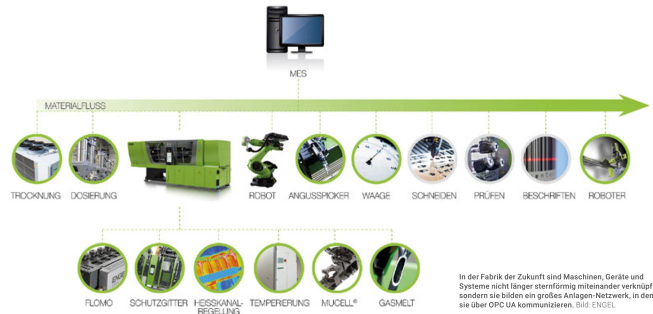
In der Fabrik der Zukunft sind Maschinen, Geräte und Systeme nicht länger sternförmig miteinander verknüpft, sondern sie bilden ein großes Anlagen-Netzwerk, in dem sie über OPC UA kommunizieren. Bild: ENGEL
